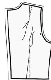
6. Обметать косой срез верхней детали спинки, подогнуть и настрочить. Сложить верхнюю деталь спинки с нижней деталью спинки от проймы до метки и стачать. Начинать и заканчивать строчку точно у метки. Обметать, заутюжить вниз. Настрочить на расстоянии 0.5 см от края. Пришить крючок и петлю к краям горловины спинки.
