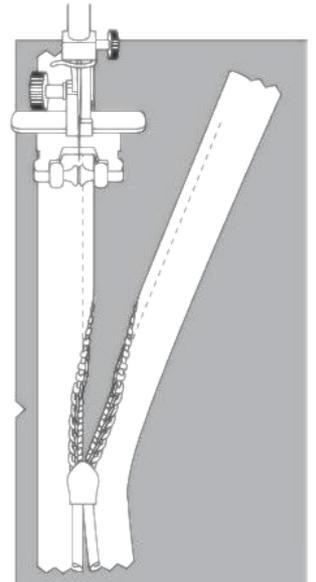
Lange Enden stehen lassen, auf die Abseite ziehen, verknoten und Faden abschneiden.
