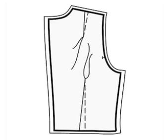
4. Die schräge Kante des oberen Rückens versäubern, nach unten falten und absteppen. Das obere Rückenteil von der Armlochkante bis zur Markierung an das untere Rückenteil stecken und nähen. Beginnen und stoppen Sie die Naht genau an der Markierung. Naht versäubern, nach unten bügeln. 0,5 cm von der Naht absteppen. An die Ecken des Rückenausschnitts ein Ösenhäkchen nähen.
